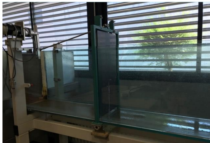
FIGURE 4 – Configuration expérimentale du problème : Générateur de vagues
